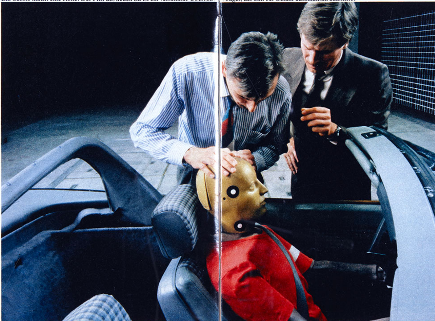
Techniker untersuchen den Kopf des Dummies nach dem Überschlag. Die Pl
