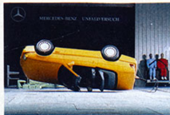
Ein Cabrio macht eine Rolle. Der Pfiff des neuen SL ist ein versenkter Überrollbügel, der sich bei Gefahr automatisch aufrichtet
