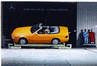
Ein Cabrio macht eine Rolle. Der Pfiff des neuen SL ist ein versenkter Überrollbügel, der sich bei Gefahr automatisch aufrichtet
