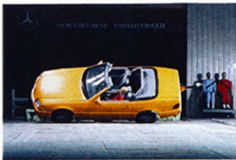
Ein Cabrio macht eine Rolle. Der Pfiff des neuen SL ist ein versenkter Überrollbügel, der sich bei Gefahr automatisch aufrichtet
